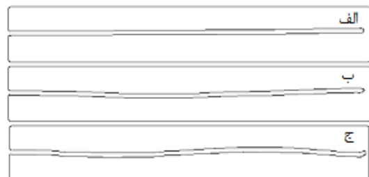
شکل ۸) اشکال مودی استخراج‌شده: الف. شکل مود اول ( \alpha=40 )، ب. شکل مود دوم ( \alpha=170 )، ج. شکل مود سوم ( \alpha=200 ) - (ارتعاش آزاد تیر فولادی با اتصال گیردار)
