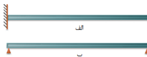
شکل ۲) پیکره بندی تیر فولادی: الف) با اتصال گیردار، ب) با اتصالات مفصلی
