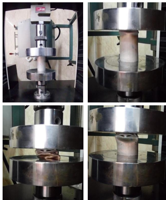
شکل ۱۰) نمونه آلومینیومی ساده در وضعیت‌های مختلف تحت آزمایش بارگذاری فشاری شبه استاتیکی.
