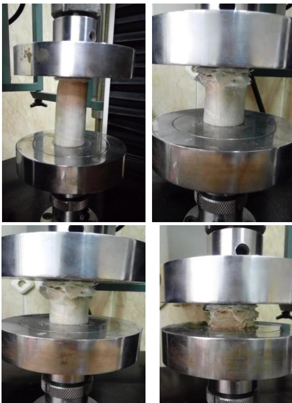
شکل ۱۱) نمونه ترکیبی آلومینیوم/کامپوزیت تحت بارگذاری فشاری شبه‌استاتیکی.
