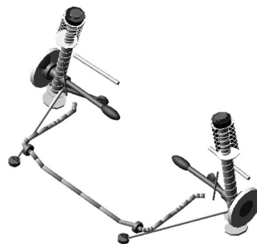
شکل 4 سیستم تعلیق جلو، مک فرسون، شبیه‌سازی شده در نرم‌افزار آدمز
