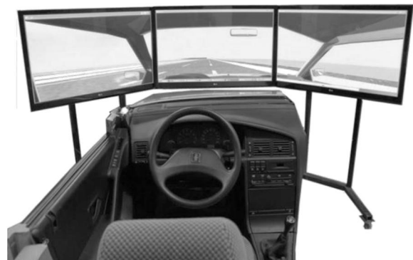
شکل 3 شبیه‌ساز رانندگی سکو ثابت پژو 405
