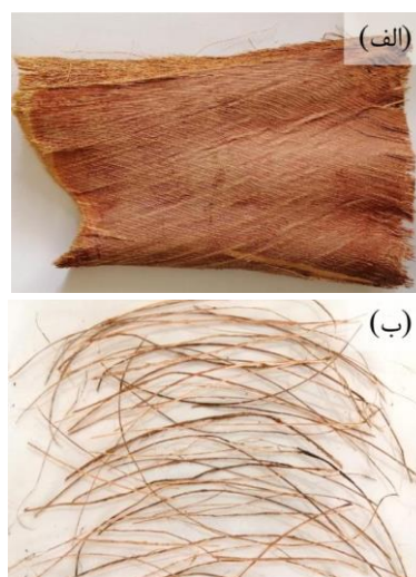
شکل ۱) الف) تار و پود در هم تنیده الیاف در پوشش انتهایی شاخه های نخل خرما، ب) الیاف استخراج شده
