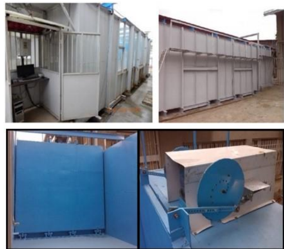
شکل ۳) نمای چپ و راست استخر موج و موج‌ساز موجود در گروه پژوهشی انرژی‌های دریا پایه
