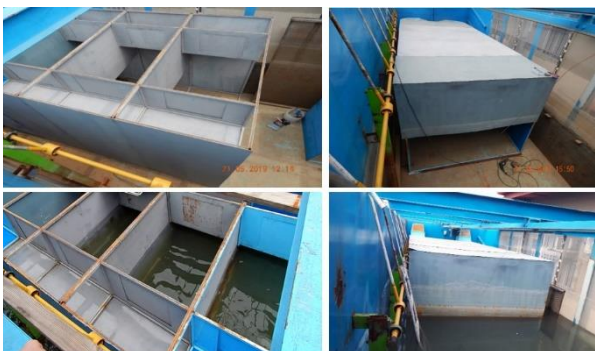
شکل ۲) نمونه مبدل انرژی موج ساخته شده در آزمایشگاه با مقیاس ۱:۱۰
