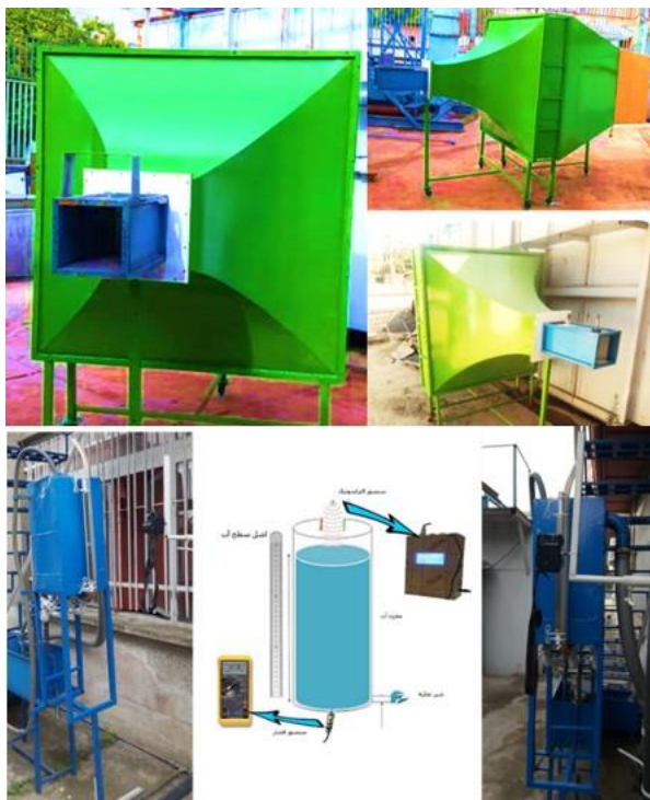
شکل ۵) استفاده از مخزن، دوربین و خط کش به منظور کالیبراسیون سنسور سطح‌سنج و تونل باد برای کالیبراسیون سرعت سنج
