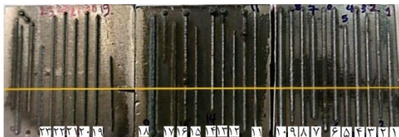
شکل ۱۳) تصویر نمونه‌های مرحله دوم برای به‌دست آوردن کمترین نسبت آمیختگی.
