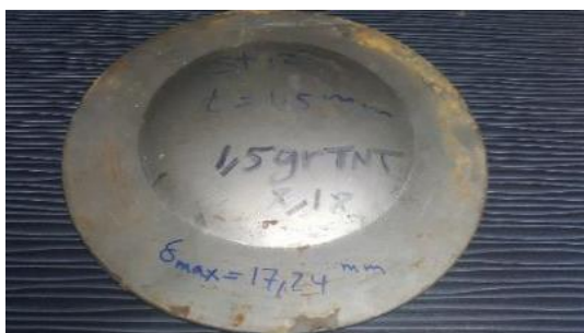
Fig. 8 Deflection of 1.5 mm steel plate during loading 1.5 gram T.N.T شکل 8 تغییر شکل ورق فولادی با ضخامت 1.5 میلی‌متر تحت بارگذاری بار انفجاری حاصل از 1.5 گرم TNT
