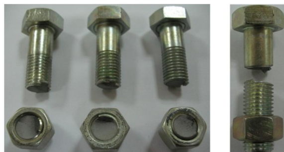
شکست نامعتبر شکست معتبر شکل 6 نمونه‌های پیچ M12 پس از شکست
