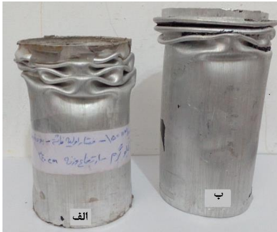
شکل ۱) فروریزش جاذب استوانه‌ای؛ (الف) بدون فشردگی هوا، (ب) همراه با فشردگی هوا
