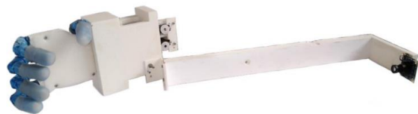
شکل ۸) اتصال دوربین به دست ربات
