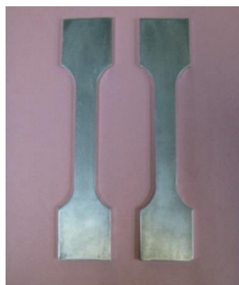
Fig. 9 Tensile test samples according to ASTM E 8 شکل 9 قطعات نمونه تست کشش مطابق استاندارد ASTM E 8
