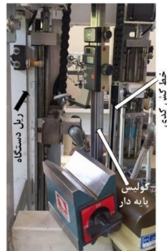
شکل ۶) اندازه‌گیری خطاهای موقعیت‌دهی محورهای حرکتی
