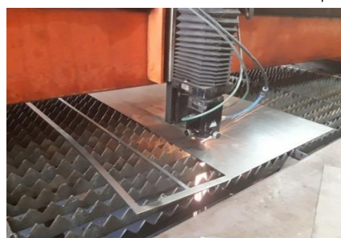
شکل ۴) سوراخ زدن و برش ورق با دستگاه لیزر
