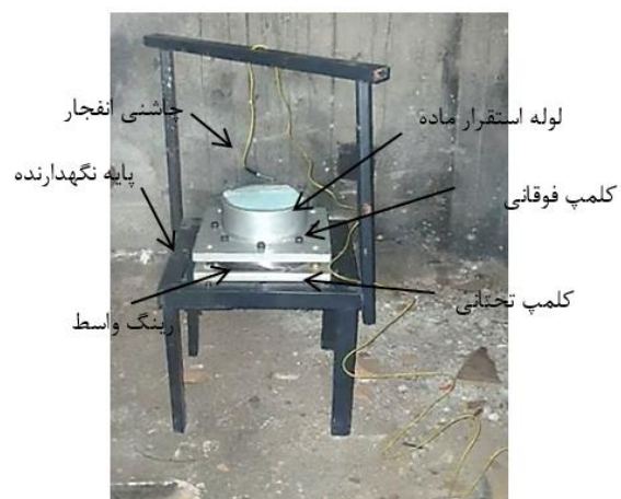
شکل ۵) نمونه در حال آماده سازی در اتاق انفجار گیره پایینی توسط ۴ پیچ بر روی پایه تکیه‌گاه نصب می‌شود. سپس ورق تحتانی با تطبیق سوراخ‌های اطراف بر روی کلمپ تحتانی قرار می‌گیرد. در مرحله بعد، رینگ دایره‌ای واسط در سطح
