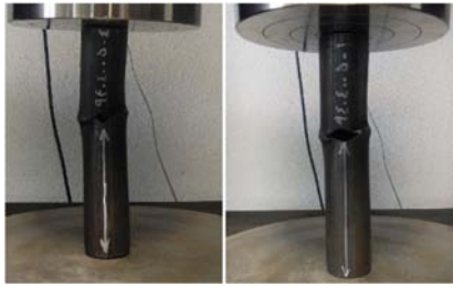
Fig. 6 figure of (5-1-C 150) and (5-4-L 150), after buckling شکل 6 شکل نمونه (5-1-C 150) و (5-4-L 150)، بعد از کمانش
