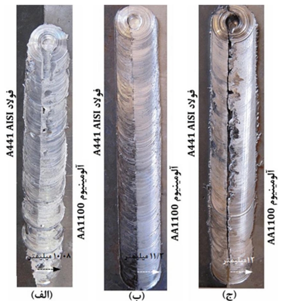
شکل 10 نمونه‌های جوشکاری شده در سرعت دورانی 500 دور در دقیقه و افست (الف) 0/8، (ب) 1/3 و (ج) 2 میلی‌متر در درون آلومینیوم
