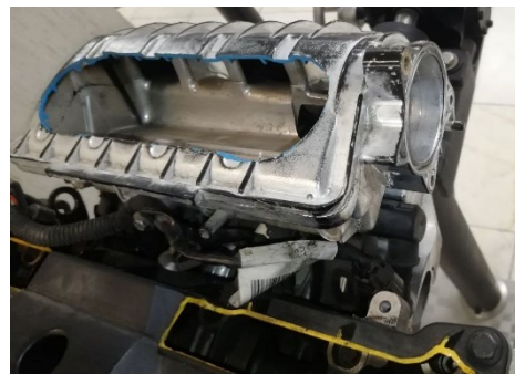
شکل (۳) مدل برش خرده منی فولد موتور EC5 که حجم مشدد در پشت آن با دو مجرا به آن اتصال دارد.
