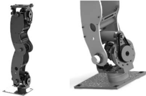
Fig. 2 Entire structure and ankle drive system of SURENAIII's left leg شکل 2 ساختار کلی و سیستم تحریک مچ پا چپ ربات سورنا 3
