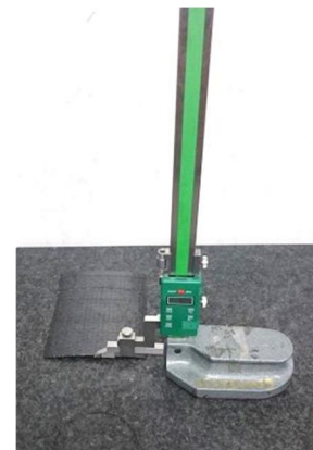
Fig.9 Measuring the displacement of the laminate by a height gauge شکل 9 اندازه‌گیری جابجایی خارج از صفحه ورق توسط دستگاه ارتفاع سنج
