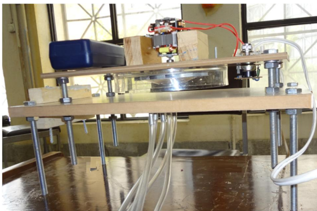
شکل 3 دستگاه ساخته شده جهت آزمایش جاذب گردابه‌ای
