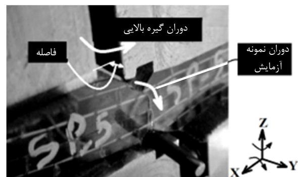
شکل 13 نمایش دوران گیره بالایی و نمونه آزمایش
