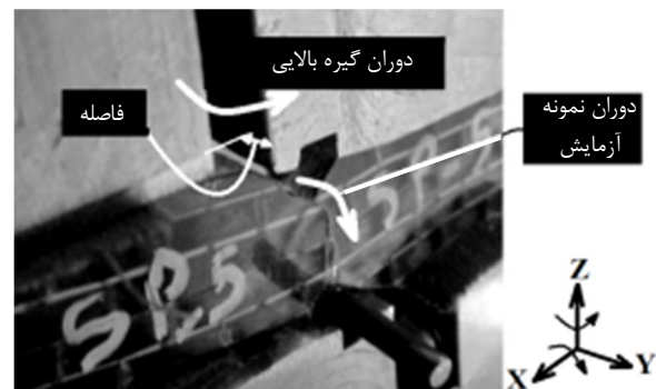
شکل 13 نمایش دوران گیره بالایی و نمونه آزمایش
