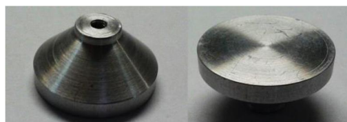
شکل 10 دو نما از جرم سر آلومینیومی
