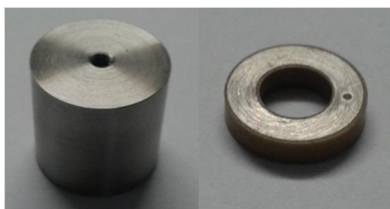
شکل 11 جرم دنباله فولادی (سمت راست) و رینگ پیزوسرامیک (سمت چپ)
