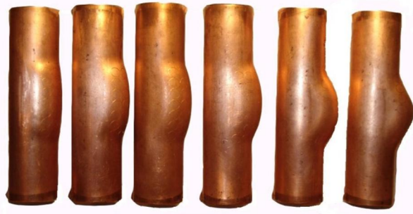
شکل 5 لوله‌های تغییرشکل یافته در آزمایش بالچ
