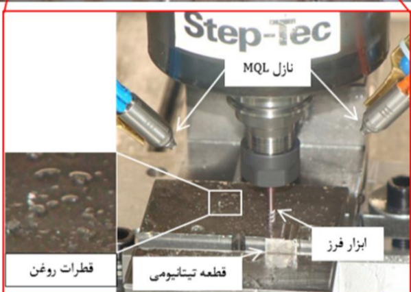
شکل 1 چیدمان انجام آزمایش و نحوه اعمال روان کاری در فرزکاری سرعت بالا
